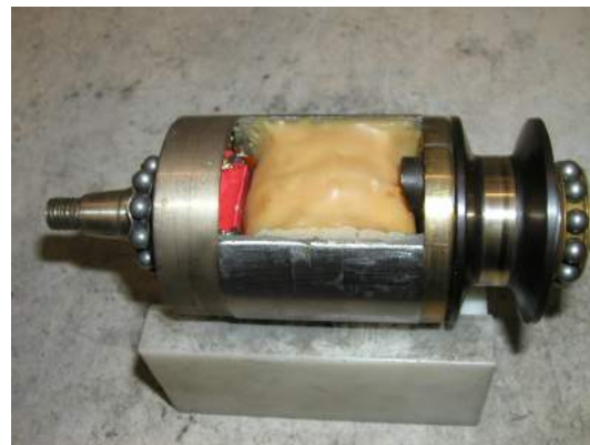
Anker einbaufertig montiert. < A Ankerendstücke B >
