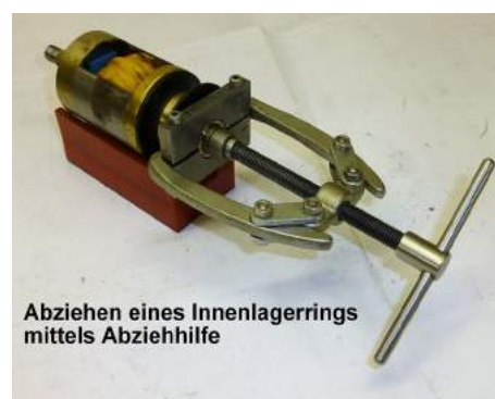
Beispiel für das Abziehen von Innenlagerringen und Schleifring (es gibt natürlich auch noch andere Systeme)
