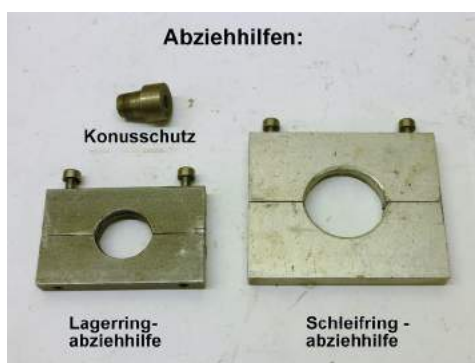
Beispiel für das Abziehen von Innenlagerringen und Schleifring (es gibt natürlich auch noch andere Systeme)
