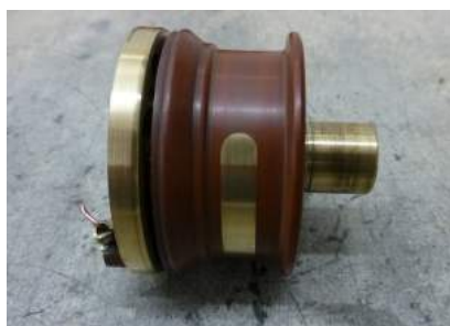
„Dicker“ Schleifring am Bosch FF/FC (beide Ankerendstücke „schmal“)
