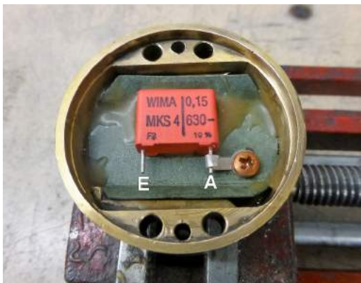
Marelli MLA: Kondensator eingeklebt. A = Primär - Anfang: an Masse. E = Primär - Ende: zum B-Endstück.
