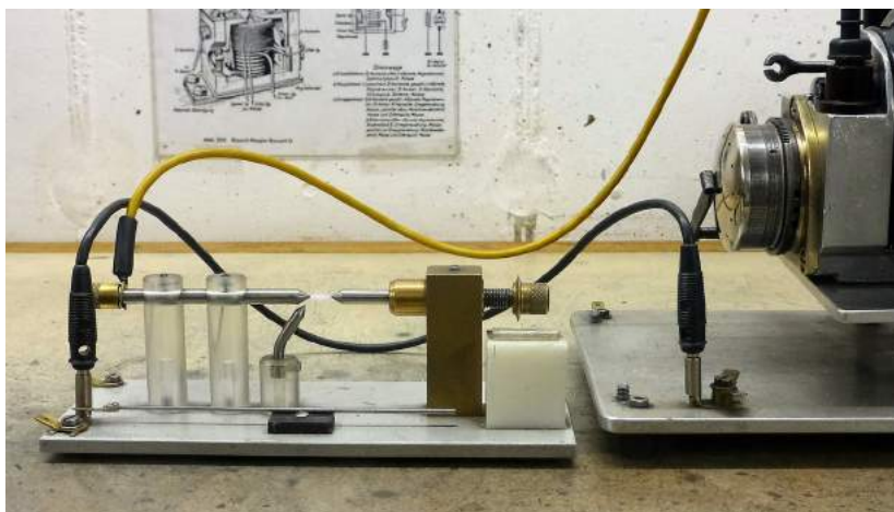
Testlauf eines Marelli - Zünders an der Testfunkenstrecke beim Verfasser. Schlagweite einstellbar; hier 8 Millimeter, entsprechend 13000 Volt
