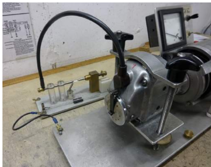
Testlauf eines restaurierten Zünders (2000 U/min; mindestens 30 Minuten): Funkenstrecke auf 8 mm eingestellt (entsprechend 13000 Volt)
