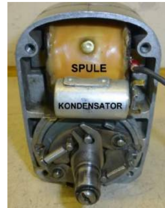
Das Kabel rechts (Primärende) führt zum Kondensator
