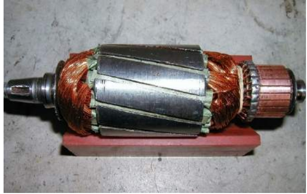
Ankerwicklung fertig; Scheibe und Lagerringe aufgezogen. - Die Schrägstellung der Nuten dient der Minderung des elektrischen Laufgeräusches.
