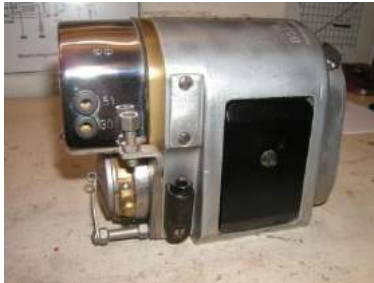
Lichtmagnet – Zünder oben Lichtteil – unten Zünderteil
