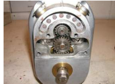
Getriebe mit Zwischenrad oben die Öler und der Schmierfilz
