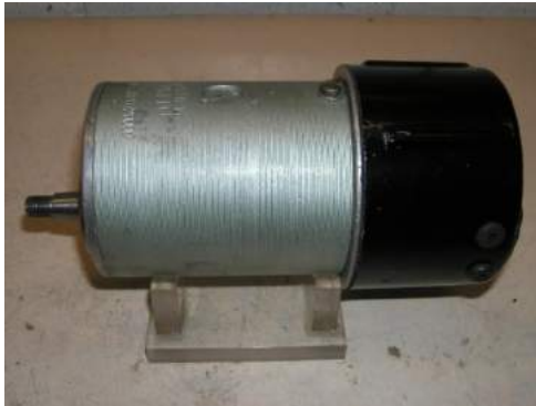
Marelli – Gleichstrom – Rundlichtmaschine Type DN – 30/6/2000 - 6 Volt 30 Watt Der Regler befindet sich unter der Abdeckkappe
