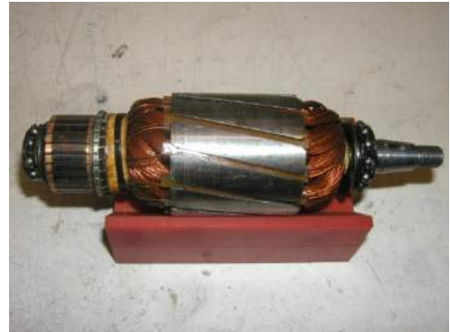
Anker der Lichtmaschine: links der Kollektor mit seiner „Laufpatina“ mittig das Blechpaket mit der Ankerwicklung rechts der Antriebszapfen
