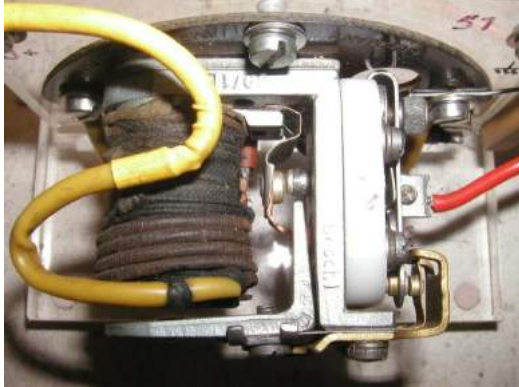
Spule - Ankerflügel - Schaltkontakt - Regelkontakt
