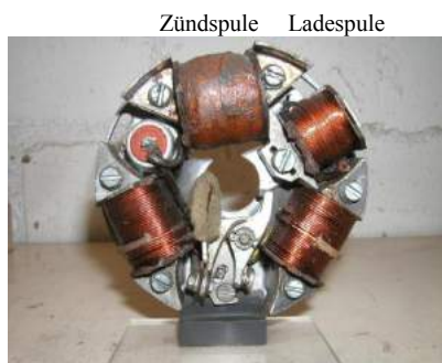
Zündspule Ladespule Lichtspule - Unterbrecher - Lichtspule Kontakt - und Spulenplatte
