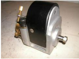
Bügelmagnet – Zünder (hier: Bosch Type FF 1)
