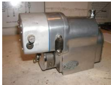
Lichtbatterie – Zünder oben Lichtteil - unten Unterbrecherwelle
