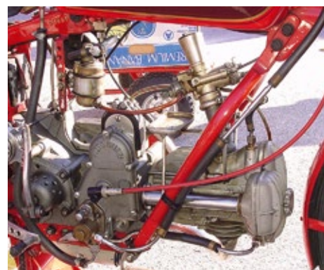
Noch bevor Moto Guzzi einen gekapselten Ventiltrieb entwickelt hatte, bot die Turiner Firma Velox einen Zylinderkopf aus Aluminium so geschlossenem Ventiltrieb an.
