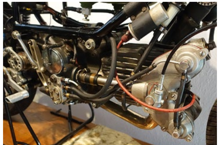
Die Krönung des Einzylindermotors war die Bialbero mit Königswelle und zwei oberliegenden Nockenwellen. Mit tiefem Schwerpunkt, gutem Fahrwerk, wenig Gewicht und einer im eigenen Windkanal entwickelten Verkleidung war die Maschine lange im Rennsport erfolgreich.
