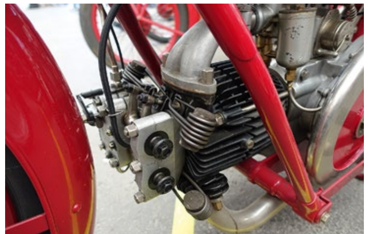
Die C4V mit Königswelle. Zum Kopf führen Ölleitungen hin und zurück um die Nockenwelle und ihren Antrieb zu schmieren. Die Ventileinstellschrauben sind leicht zugänglich. Die Korken in den Haarnadelfedern dienen zur Schwingungsdämpfung.
