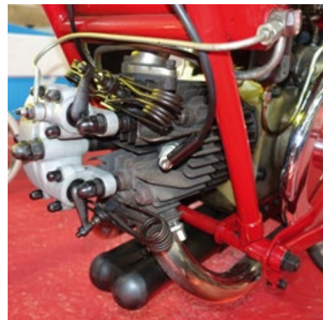
Der Ventiltrieb der P 175 fand sich auch schnell in den Halblitermodellen wieder. Aus dem Kipphebelgehäuse schaut jeweils nur ein Arm der Kipphebel hinaus.
