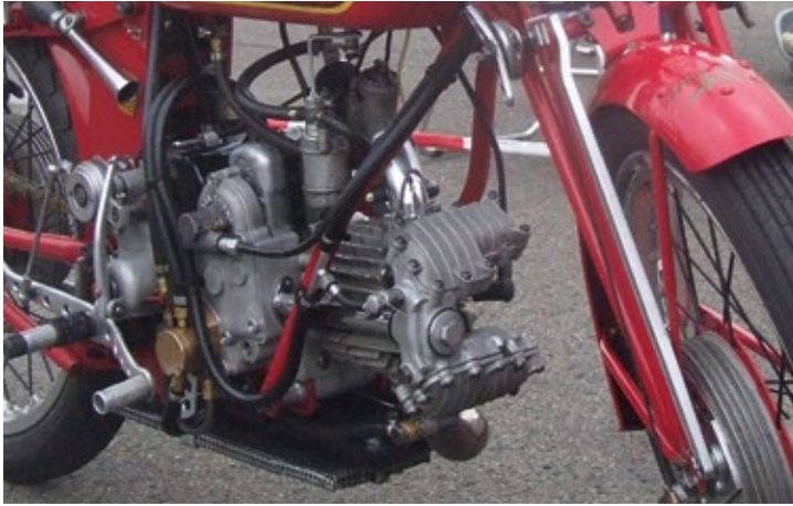
Bei den meisten späteren Modellen kam ein komplett gekapselter Ventiltrieb mit zwei Deckeln und einer Verschlusschraube zum Einsatz.
