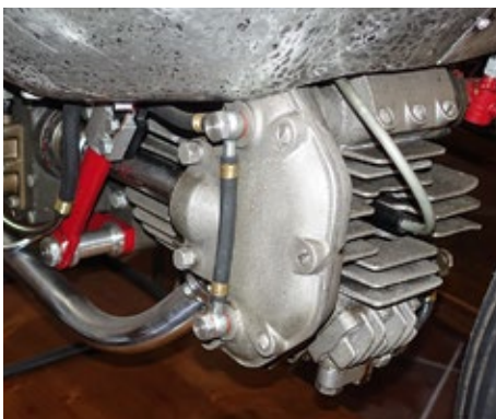
Auch von den Bialberos gab es unterschiedliche Ausführungen. Bei den Motoren mit zwei oberliegenden Nockenwellen werden die Ventile direkt über Tassenstößel geöffnet.
