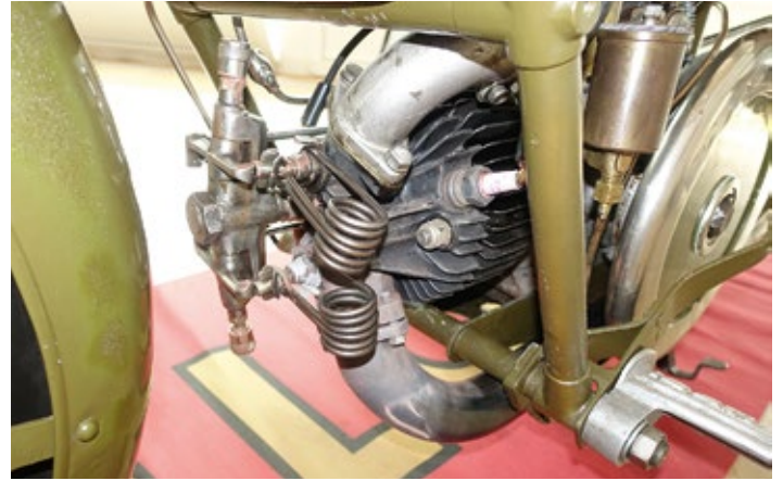
Der offene Ventiltrieb der C2V – mit zusätzlichen Zugfedern an den Kipphebeln und Fettbuchsen zur manuellen Schmierung der Kipphebelwellen. Die Zündkerze ist nicht optimal seitlich positioniert. Die Ventileinstellschrauben befinden sich zugesperrt am unteren Ende der Stößelstangen.
