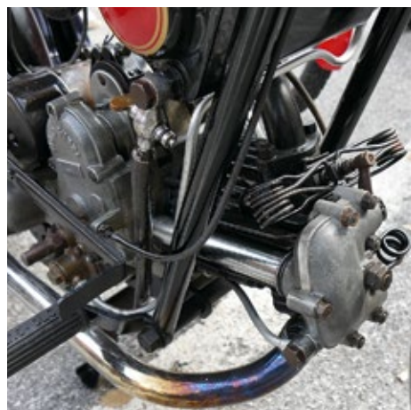
Keine Königschelle, in dem Hüllrohr bewegen sich zwei von einer untenliegenden Nockenwelle betätigte Stößelstangen auf und ab.
