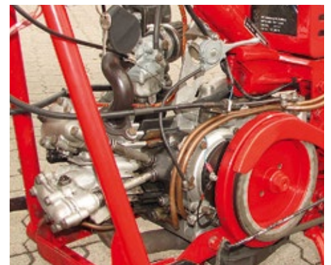
Ein Galletto ohne Blechkleid. Hier befindet sich der Ventiltrieb auf der linken Seite und die Stößelstangen verlaufen nicht parallel zueinander.
