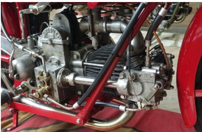
Die C4V mit Königswelle. Zum Kopf führen Ölleitungen hin und zurück um die Nockenwelle und ihren Antrieb zu schmieren. Die Ventileinstellschrauben sind leicht zugänglich. Die Korken in den Haarnadelfedern dienen zur Schwingungsdämpfung.
