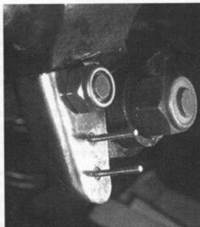
Halter mit angeschweißten Schrauben M2
