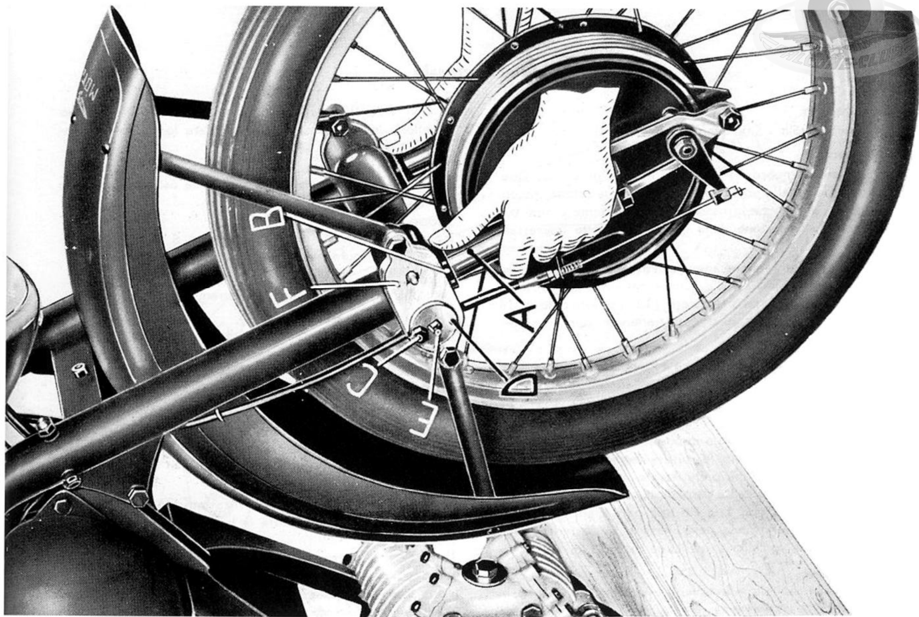
Fig. 33 - Registrazione della forcella telescopica
