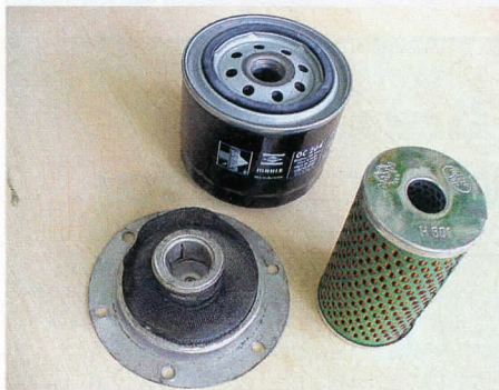
Evolution der Ölfilterung: Sieb (VW Käfer/Bus), Patrone (BMW 02) und moderner Schraubfilter
