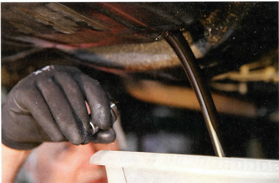
Da das Verschleißschutzadditiv ZDDP im Betrieb zerfällt, helfen auch verkürzte Ölwechselintervalle, um einen ausreichenden Motorschutz sicherzustellen
